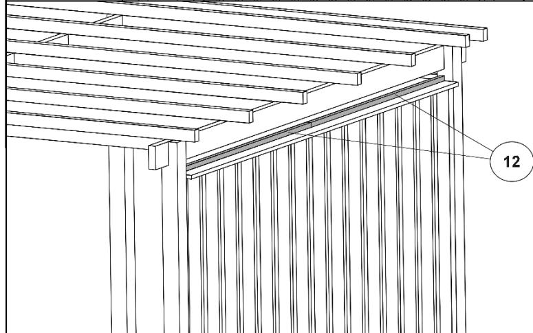
Das Glattkantbrett, Teil 10, wird an der Leiste, Teil 12, befestigt und verschließt damit die Öffnung oberhalb der Wand.
