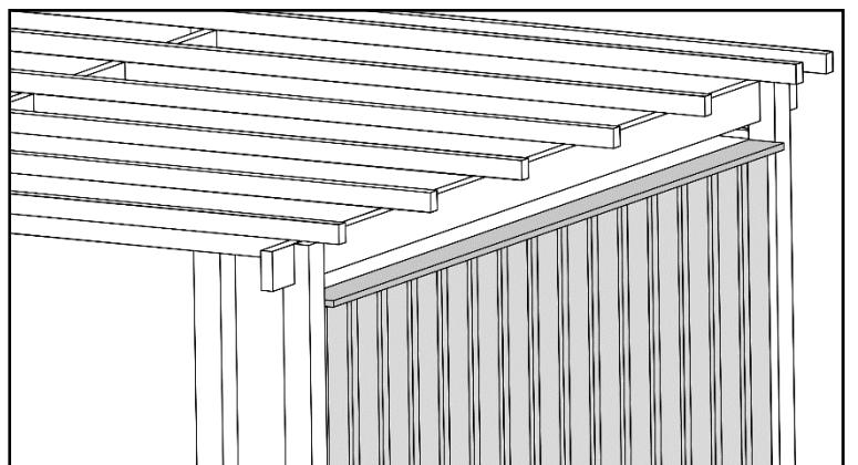
Auf die fertig montierte Wand wird die Leiste, Teil 12 hochkant aufgeschraubt.
