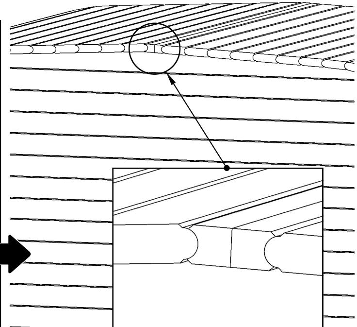
Zwei Hälften verbinden; passende Schrauben verwenden
