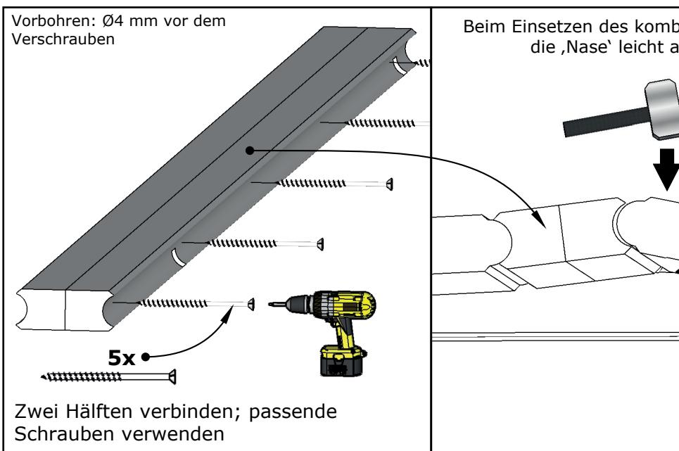
Beim Einsetzen des kombinierten Details die 'Nase' leicht anheben
