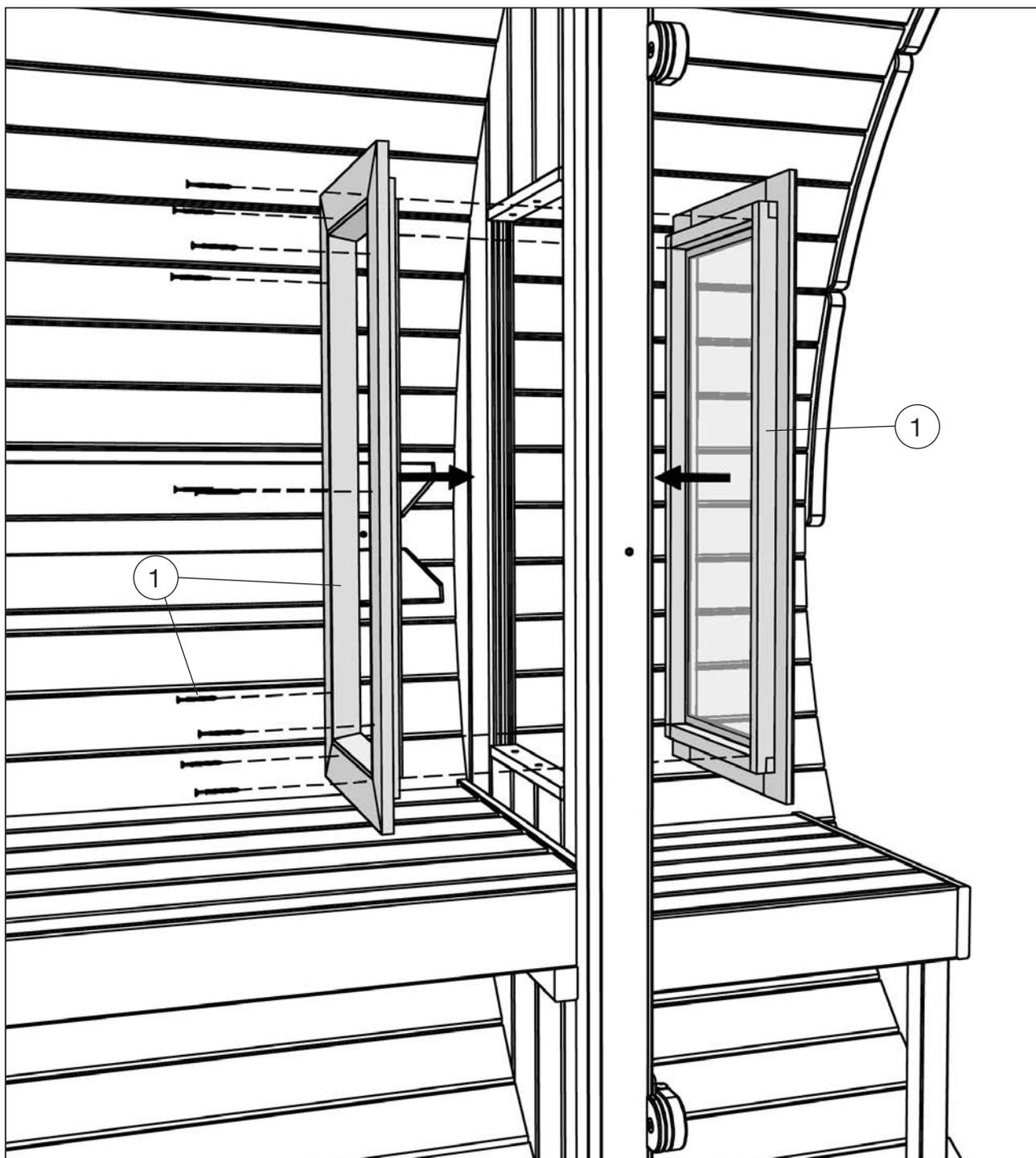
Das Fenster ist zur Gewährleistung einer kompletten Schlagregensicherheit unmittelbar nach der Montage und nach erfolgtem Anstrich mit transparentem Silikon umlaufend abzudichten. Silikon ist nicht im Lieferumfang enthalten.
